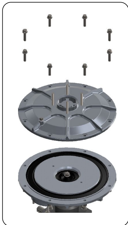
3- Desmontagem da tampa superior.
