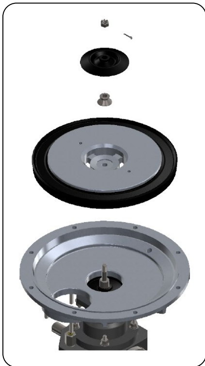
9- Remontagem do disco do atuador e válvula central.
