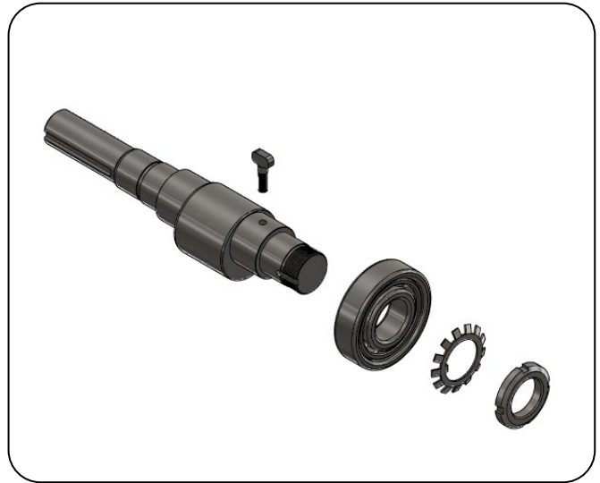
11- Desmontagem do conjunto do eixo excêntrico.
