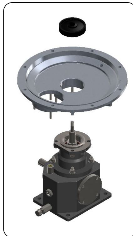
5- Desmontagem da tampa inferior.
