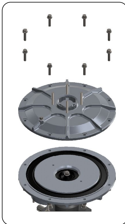
10- Remontagem da tampa superior.
